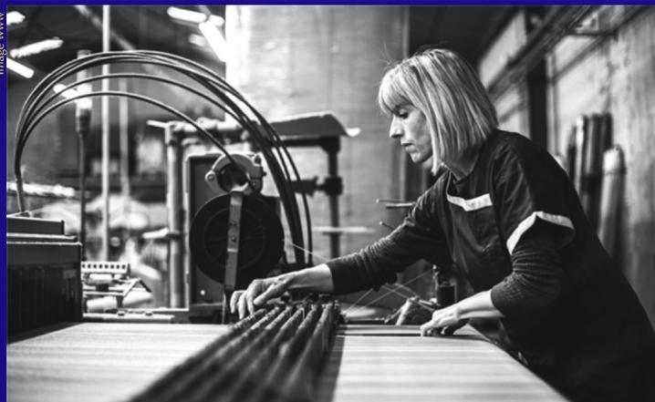
Mise en place des fils dans les lisses et le peigne.
