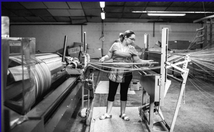
Mise en place des fils sur l'ensouple
